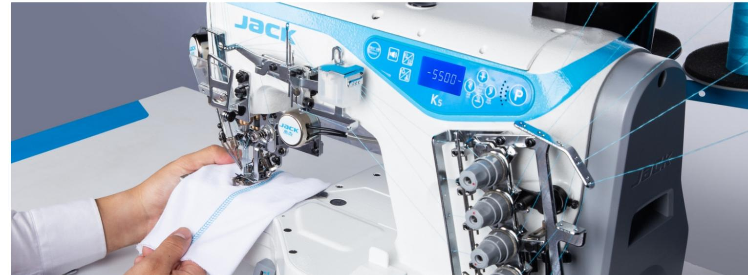
**Macchina con copertura a braccio piccolo computerizzata e ad alta velocità.**
