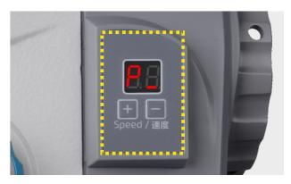
3Pannello intelligente e facile da operare Tasto unico per regolare la velocità, posizione dell'ago e reset della macchina
